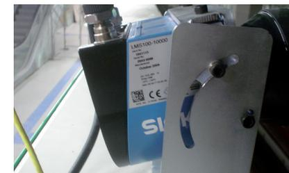
Capteur LMS100 assurant la détection d'ouverture de portes
