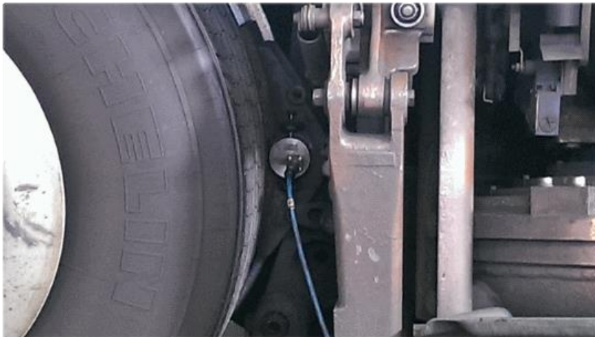
■ Photo du capteur de force de freinage sur une roue
