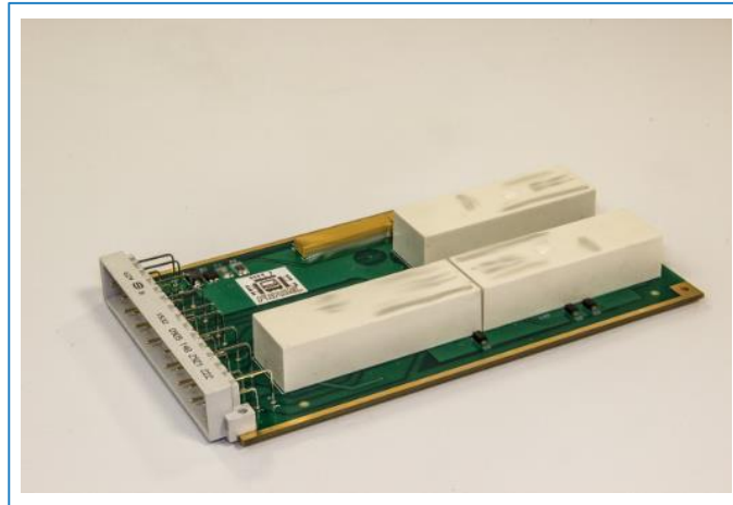
■ RS4 Dimensions : 172 x 130 x 20 mm
