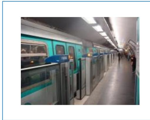
Le système DOF1 comprend une partie embarquée dans le train, qui traite les commandes d'ouverture et de fermeture des portes du train par le conducteur, et qui transmet cet ordre à une partie située dans un local technique du quai. La consigne d'ouverture y est traitée et transmise aux portes palières.
