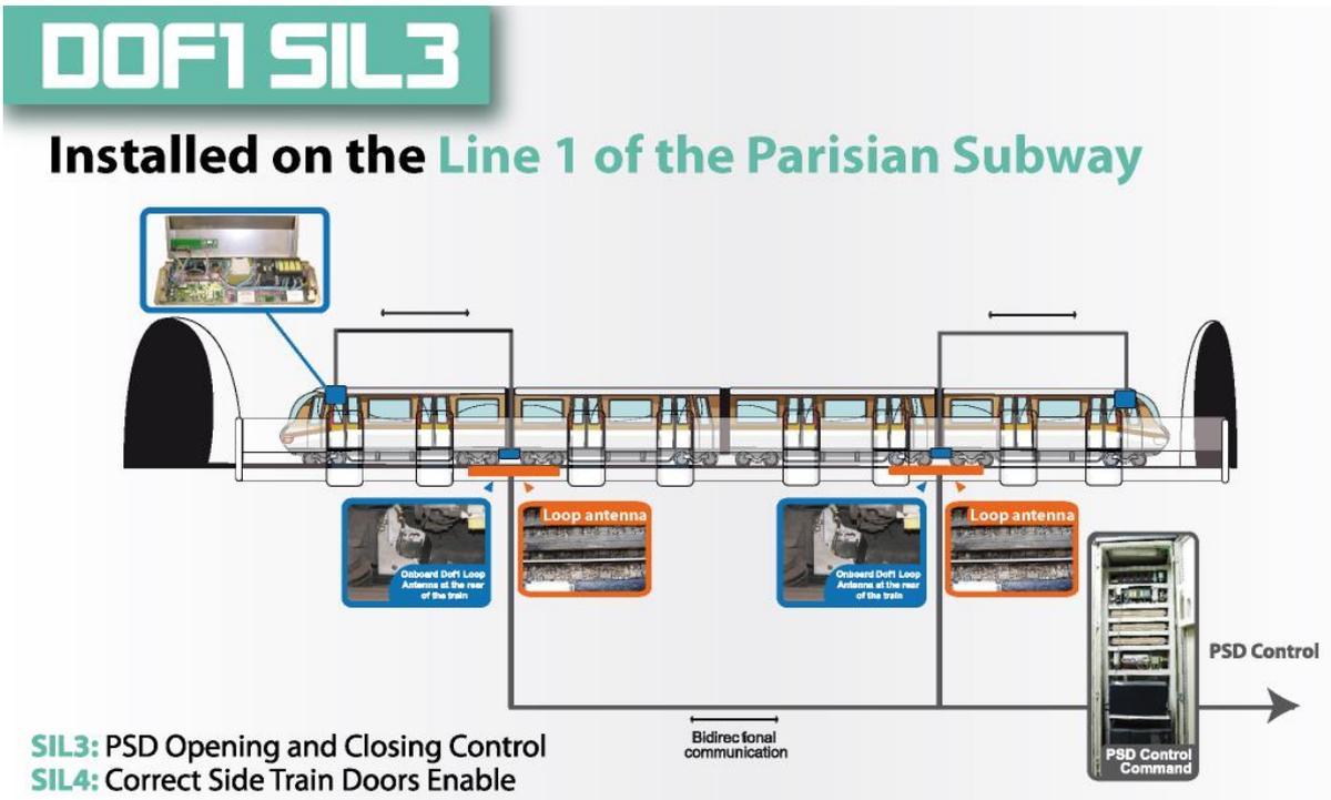
Le schéma ci-dessus décrit l'installation du système Dof1. Il comprend 2 parties :
